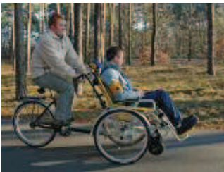
Rollfiets: Eine Kombination aus Rollstuhl und Fahrrad, bewegt durch die Muskelkraft des Partners.
